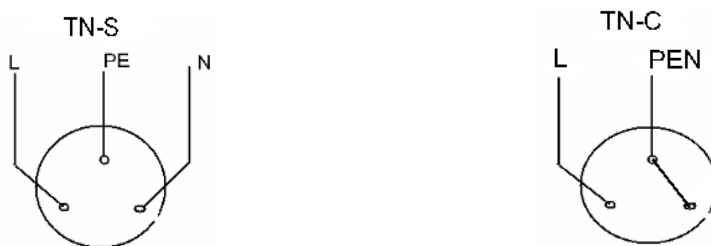
Rys 1. Schemat przyłączenia przewodów do gniazda wtyczkowego ze stykiem ochronnym w układzie sieci TN-S i TN-C
